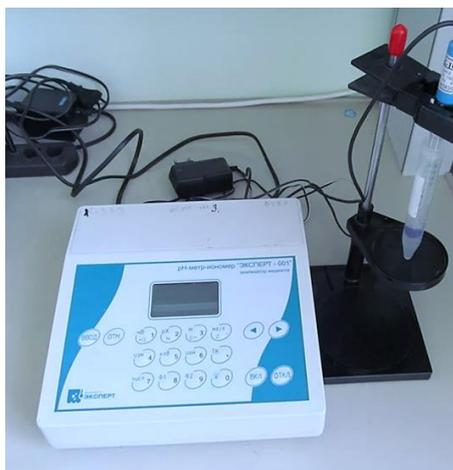
Рисунок 2.17 – Микропроцессорный анализатор pH метр-иономер «Эксперт-001»
