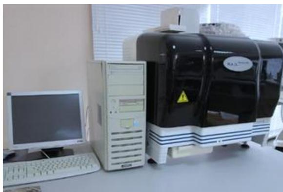
**Рисунок 2.10** – Иммуноферментный анализатор «Personal LAB»
