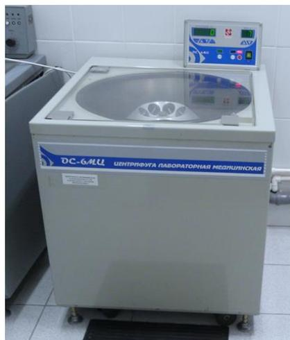
**Рисунок 2.2** – Медицинская лабораторная центрифуга «ДС-6МЦ»
