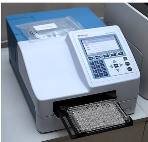
**Рисунок 2.5** – Планшетный фотометр «Multiskan FC»
