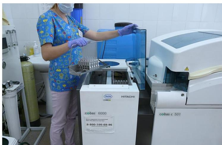
**Рисунок 2.4** – Биохимический, иммунохимический анализатор «COBAS 6000»
