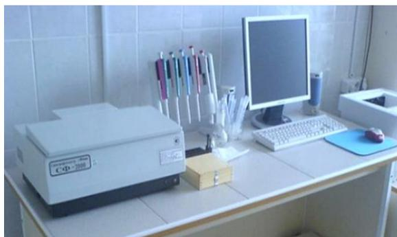
**Рисунок 2.14** – Спектрофотометр СФ-2000 «ОКБ Спектр»
