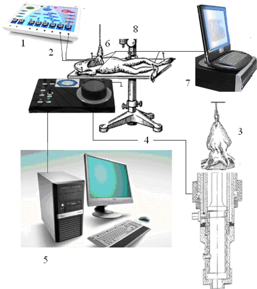
Рисунок 2.1 – Блок-схема установки для синхронной регистрации очагов свечения – маркеров очагов возбуждения в ваго-симпатических стволах и венозном синусе сердца лягушки
