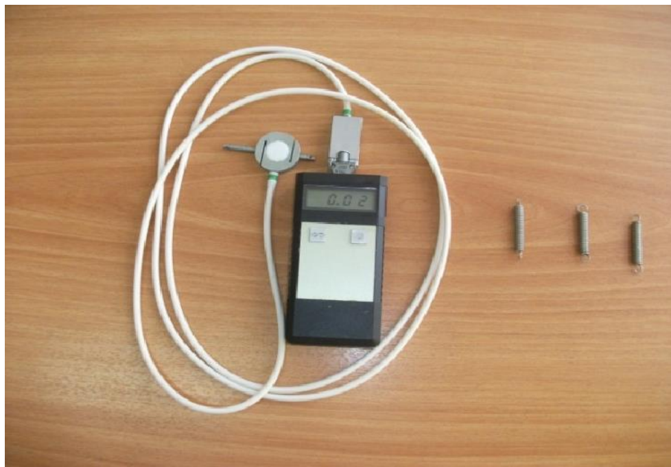
Рисунок 3.9 – Дистракционный датчик, устройство–преобразователь и тарированные пружины
