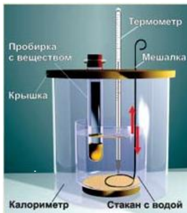
Рис. 4. Схема калориметра
