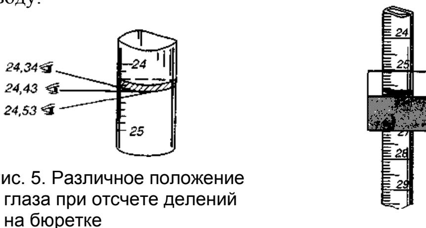
Рис. 5. Различное положение глаза при отсчете делений на бюретке
