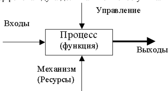
Рисунок 7.2. – Графическое представление процесса в IDEF0 (функциональный блок)
