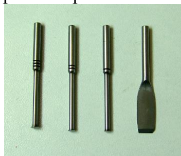
Рис. 105. Штифты – измерители степени ретенции №1, 2, 3 и штифт- нож для снятия излишков воска
