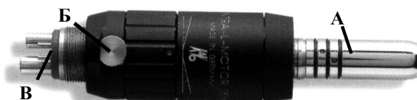
Рис. 8. Пневматический микромотор А – разъем для наконечника; Б – регулятор оборотов; В – разъем для турбинного рукава
