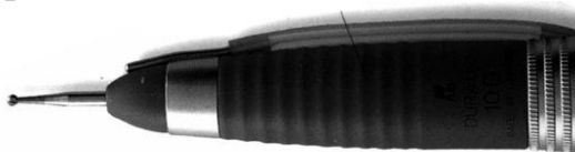
Рис. 11. Прямой наконечник 10LN KaWo (Германия).
