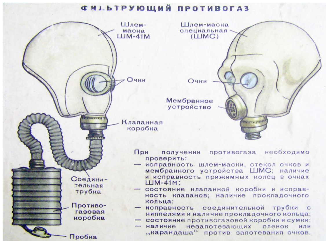
Рис. 9. Устройство фильтрующего противогаза
