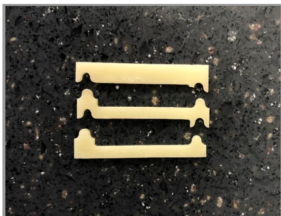
Рисунок 2.5 – Шаблон для изготовления образцов композитов в разобранном состоянии
