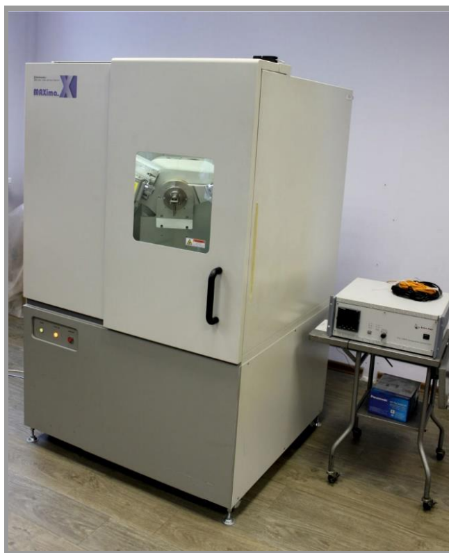
Рисунок 2.19 – Дифрактометр рентгеновский «XRD-7000» фирмы «Shimadzu» (Япония)
