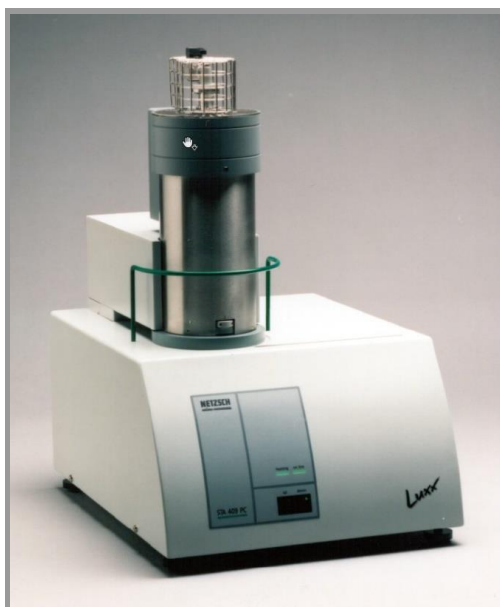
Рисунок 2.15 – Синхронный ТГ-ДТА/ДСК анализатор «STA 409 PC/PG Luxx®» фирмы «Netzsch» (Германия)
