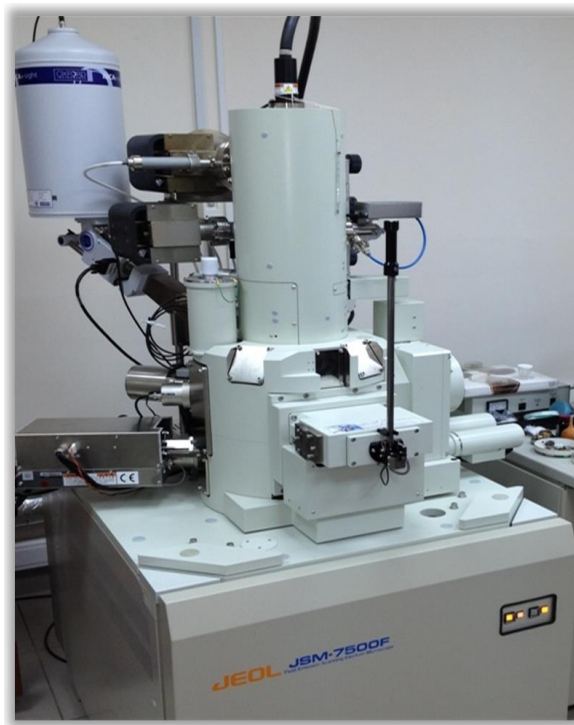
Рисунок 2.25 – Автоэмиссионный растровый электронно-сканирующий микроскоп сверхвысокого разрешения «JSM-7500F» фирмы «Jeol» (Япония)
