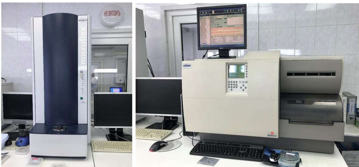
**Рисунок 2.5.1** – Масс-спектрометр MALDI Biotyper 3 BRUKER
