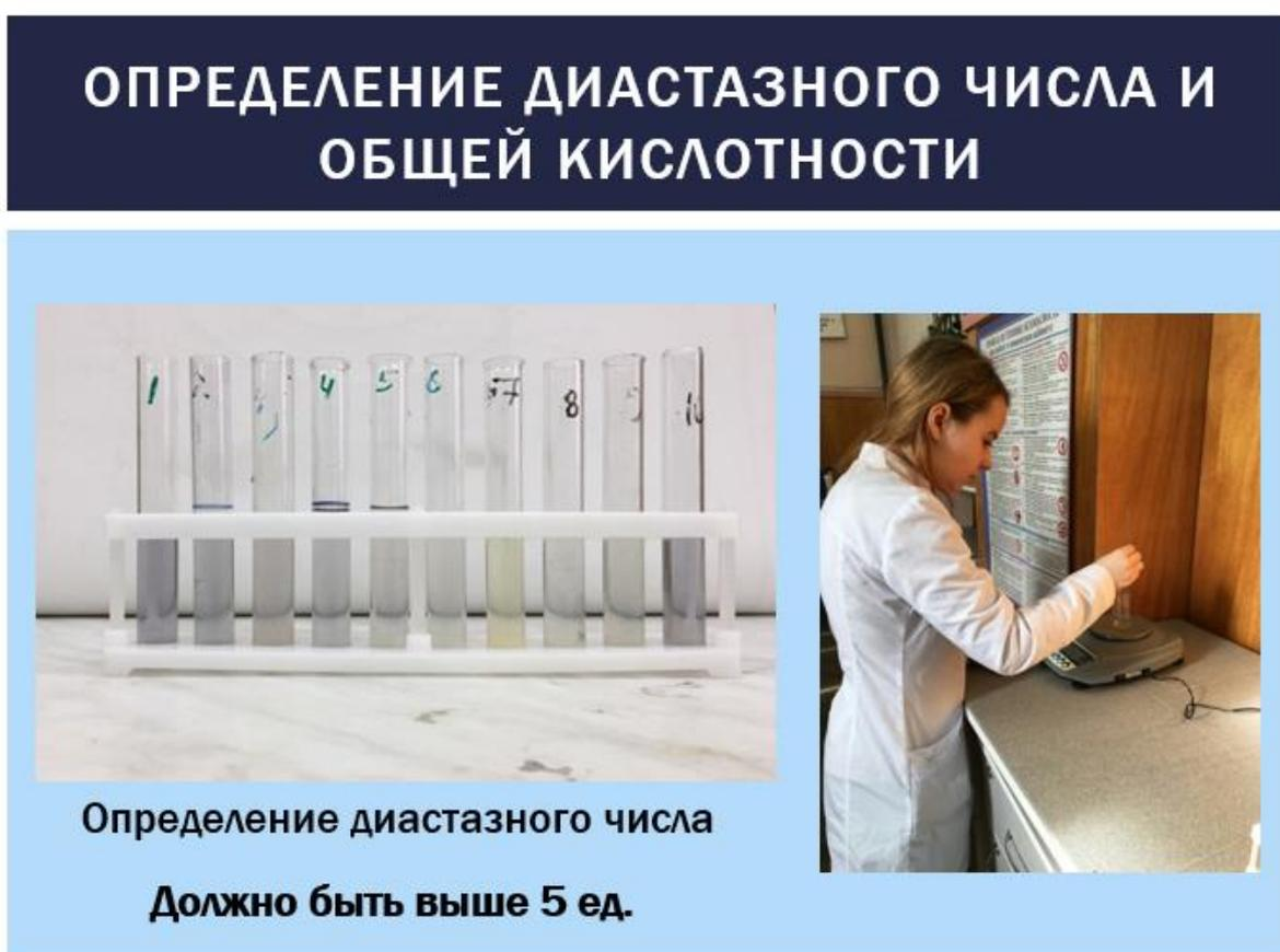
**Рисунок 9** – Определение диастазного числа качественным методом
