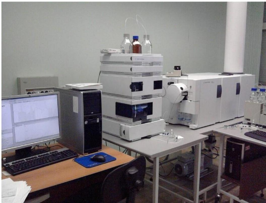
**Рисунок 2.15** – Спектрофотометрический детектор Shimadzu SPD-M20 (Shimadzu, Japan)
