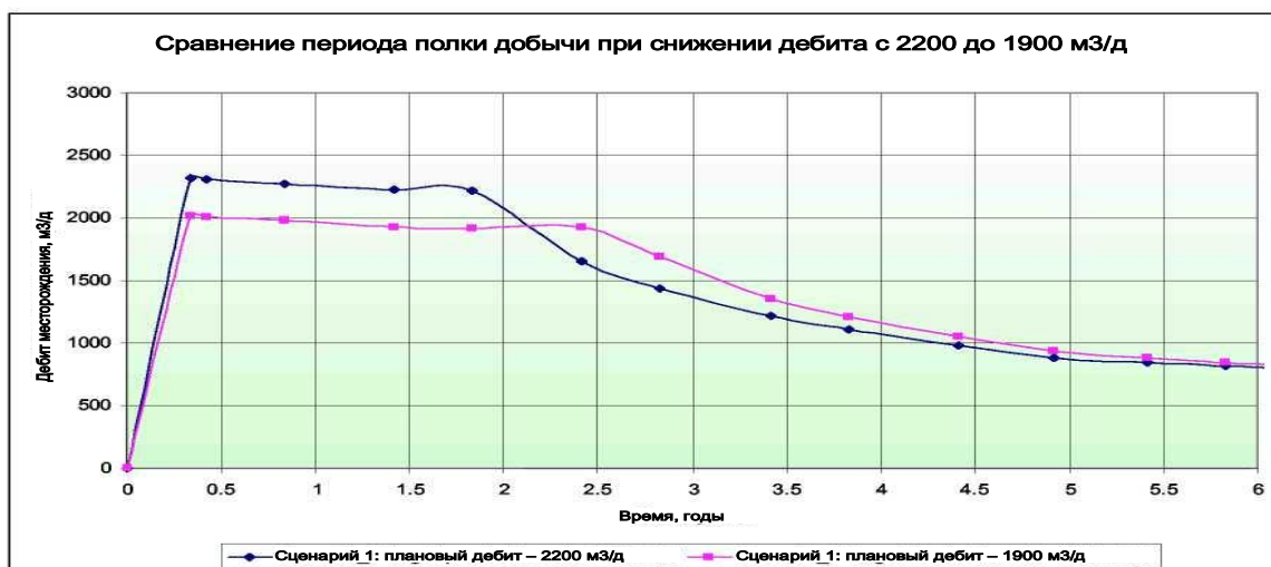
Рис.8. Исследование снижения выработки до 1900м 3 в сутки, вариант № 2
