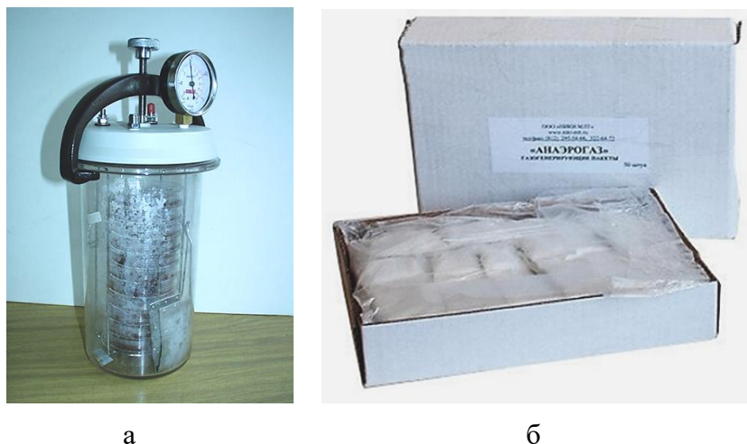
Рисунок 2.9 – Анаэростат «АЭ-01» (а) и газогенераторные пакеты «АНАЭРОГАЗ» для анаэробного культивирования
