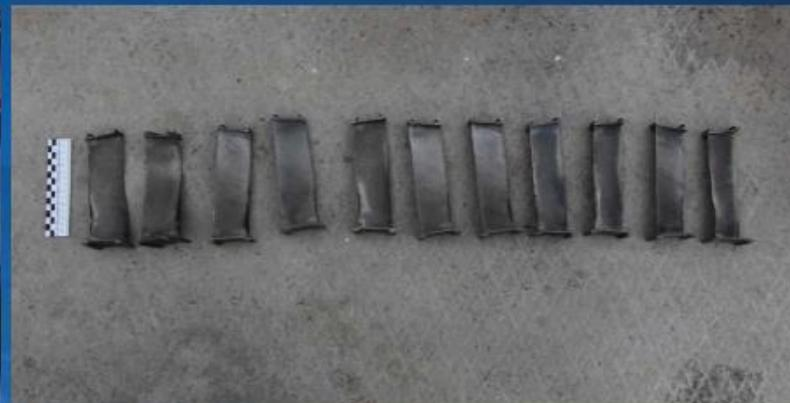
Многочисленные повреждения лопаток ступеней компрессоров двигателей. На некоторых лопатках криминалистическими средствами обнаружены неочевидные следы, похожие на следы биологического материала, подвергшегося термическому воздействию
