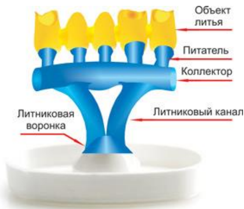
Рис. 46. Литниковая система
