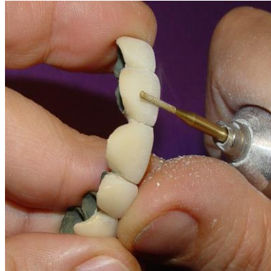
Рис. 63. Сошлифовывание фарфоровой массы
