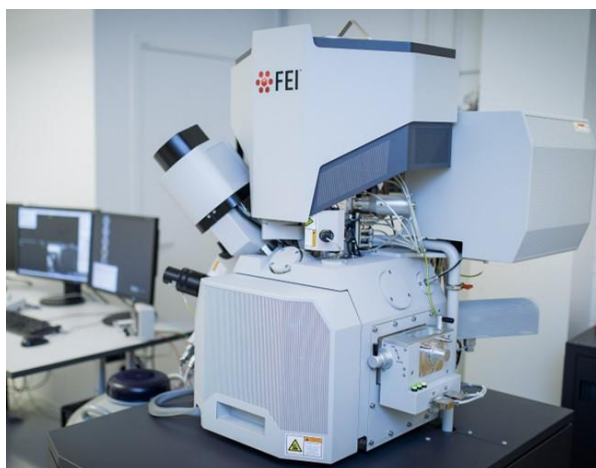
Рисунок 10 – Сканирующий электронный микроскоп Magellan XHR 400L FE-SEM-21
