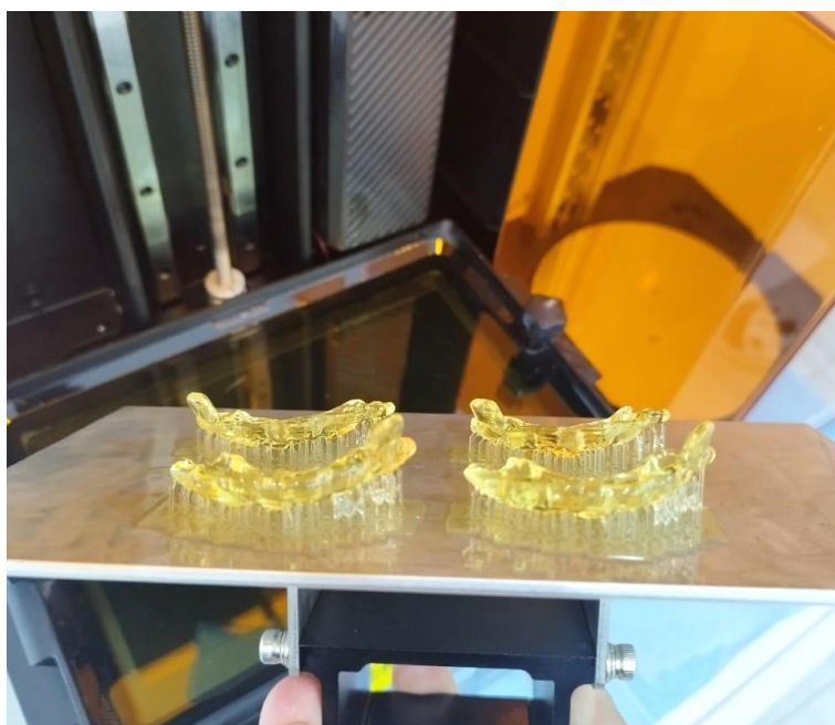
Рисунок 48 – Стереолитографический 3D-шаблон с поддержками после 3D-печати на 3D-принтере
