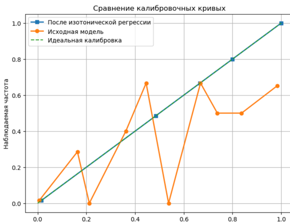
Рисунок 25 – Сравнение калибровочных кривых до и после применения изотонической регрессии
